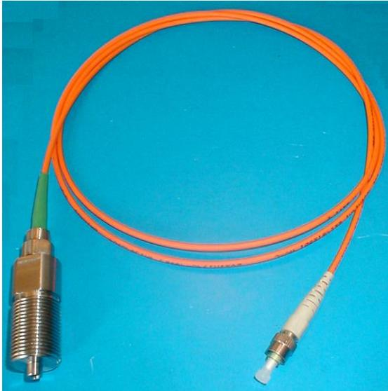
Сенсор датчика давления на основе волоконного микро-интерферометра Фабри-Перо
