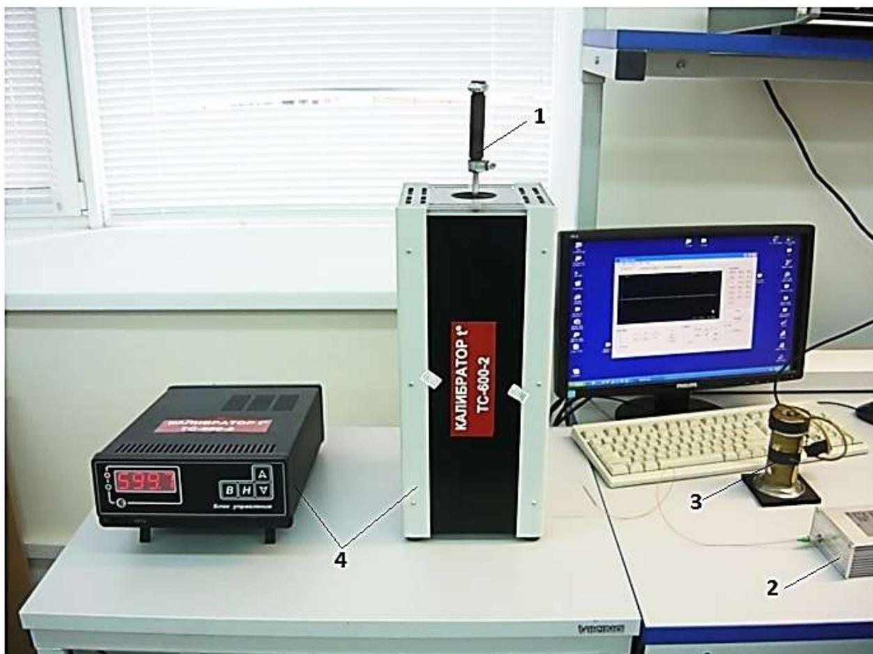
Испытание интерференционного ВОДВА при температуре **+600 °C**
