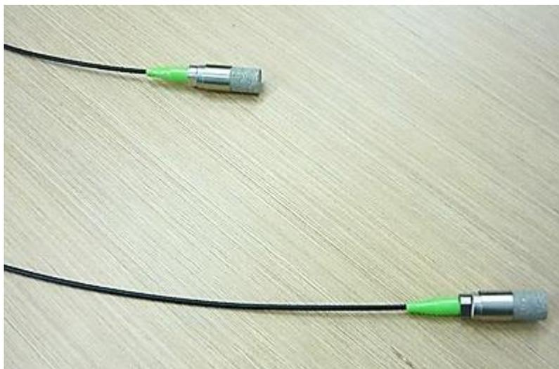
Сенсоры датчика относительной влажности на основе волоконных нано-интерферометров Фабри-Перо
