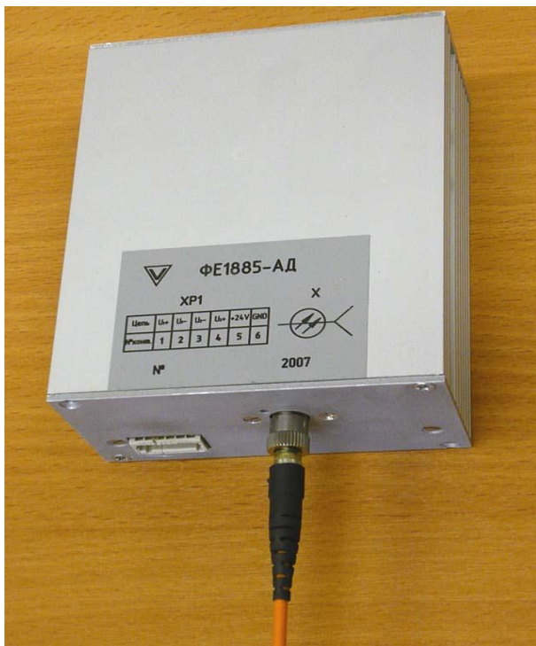
ОЭТ с аналоговым и цифровым интерфейсом без индикаторов
